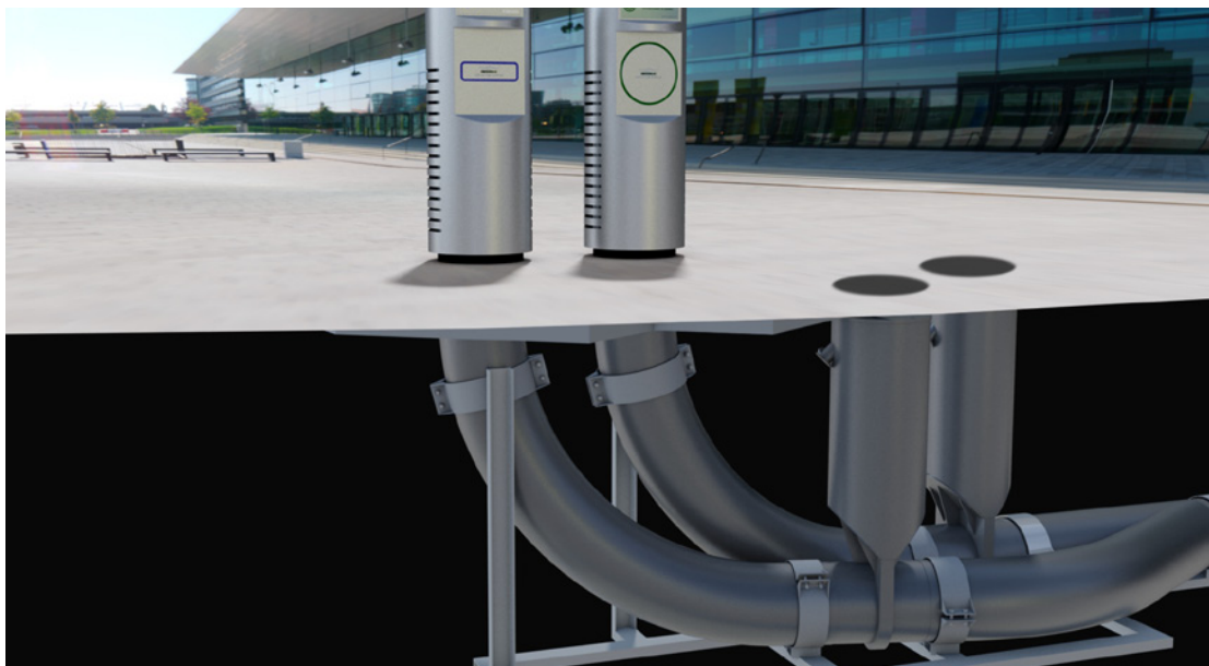
Ovan: Patenterad nedgrävd ventil med lagring i böj ger ökad mellanlagring och låg energiförbrukning.
