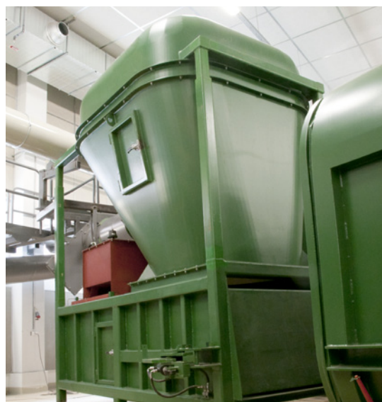
Ovan: Avskiljare och komprimator. Användning av komprimator ökar avsevärt mängden insamlat avfall i containern och reducerar samtidigt antalet transporter av containern.
